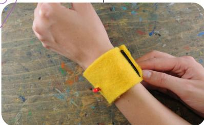
Nun kann das Armband getestet werden. Dazu wird eine Knopf-Batterie in die Batteriehalterung eingelegt. Die Plusseite der Batterie muss nach oben schauen. Wird nun das Band geschlossen, kommt die Batterie in Berührung mit dem Kupferklebestreifen auf der Plusseite. Der Stromkreis ist damit geschlossen und die LED leuchtet.
