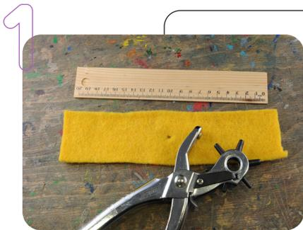
Mit einem Lineal wird die Mitte des Filzstreifens abgemessen und anschließend mit einer Lochzange oder der Spitze einer Schere ein kleines Loch für die LED gestanzt. Achtung: Das Loch muss sehr klein sein, damit die LED nicht durchfällt.
