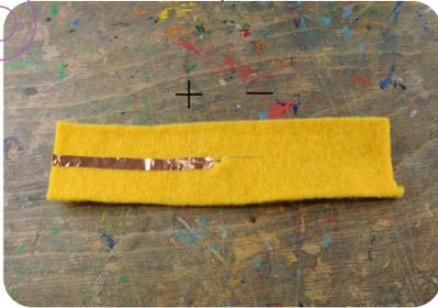
Im weiteren Arbeitsschritt wird nun ein Kupferklebestreifen vom linken Füßchen bis zum Ende des Filzstreifen geklebt. Den Kindern wird erklärt, dass das Füßchen oben auf dem Kupferklebeband (die stromleitende Seite) liegen und NICHT darunter festgeklebt werden soll. Das Füßchen wird dann mit einem Klebestreifen befestigt, sodass beide fest miteinander in Kontakt kommen.
