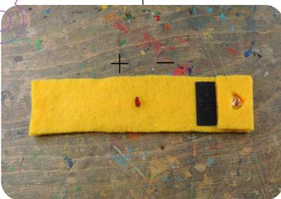
Links anschließend an die Batteriehalterung wird nun die zweite Seite des Klettverschlusses befestigt. Beachte, dass der Klettverschluss so herum geklebt wird, dass er mit dem Stück auf der Vorderseite zusammenpasst, damit er schließt.
