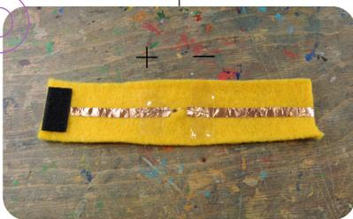
Nun wird auch auf der rechten Seite ein Kupferklebeband geklebt. Dieses sollte jedoch bis zum Ende des Filzbandes und 5cm auf der Vorderseite weitergeklebt werden (sh. Abbildung 6).
