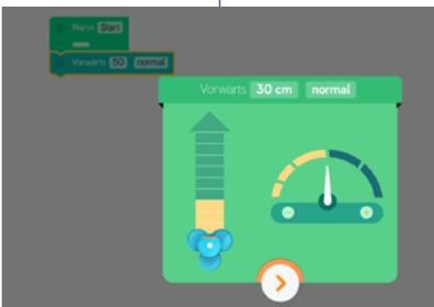
Das Bild links zeigt den Fahrbefehl „vorwärts“. Wenn auf den Block gedrückt wird, öffnet sich das Fenster, in dem Geschwindigkeit und Distanz eingestellt werden können.
