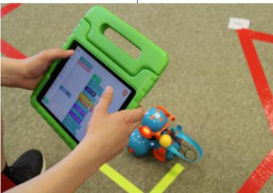
Einzelne Kommandos werden als Bausteine durch Drag & Drop aneinandergereiht. Ausgangsbaustein ist das grüne Start-Feld. Mit einem Klick auf Play (links unten) werden die Befehle anschließend nacheinander ausgeführt.
